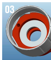
3.- Outil placé à l'intérieur du chapeau d'air
