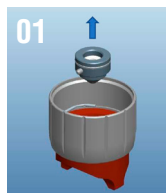
1.- Retirar el TIP de la boquilla
